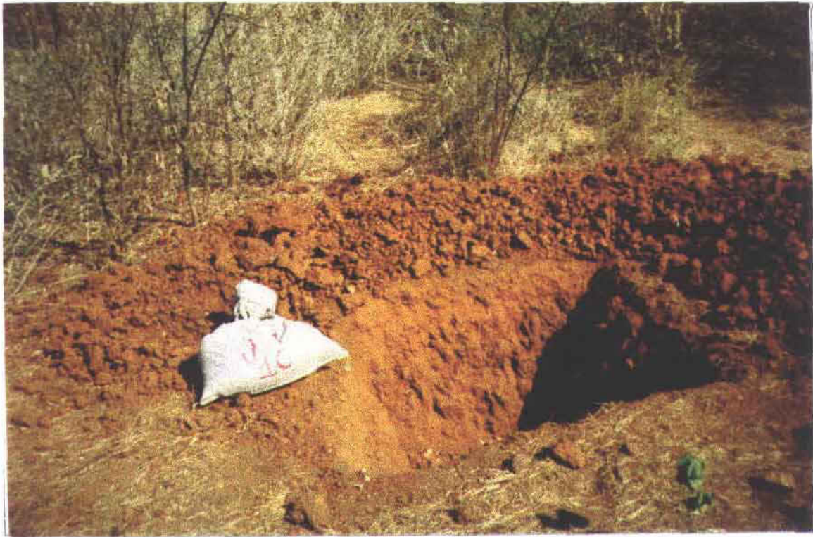
FOTO 07: JT-03/SPP-10 Jazida Terrosa composta por solo argilo-areno-siltoso apresentado horizontes pedregulhosos de eixos de quartzo subarredondados e subangulosos de pequena a média dimensões.
