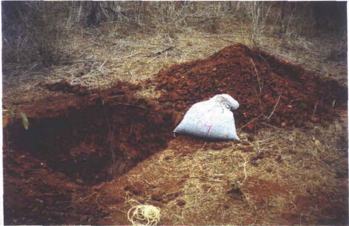
FOTO 05: JT-02/SPP-04 Jzida Terrosa apresentado solo argilo com horizontes areno-pedregulhosos de coloração vermelho alaranjado.
